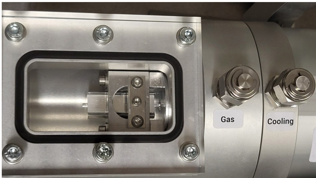
Abbildung 2: Detailansicht des Fasereingangs durch das Sichtfenster. Der Eingang wird durch ein Vorschalt-element vor Beschädigung durch potentiell fehlerhaft ausgerichtete hochenergetische Strahlen geschützt. Figure 2: Detailed view of the fiber input through the viewing window. The input is protected by an upstream protective element against damage from potentially misaligned high-energy beams.
