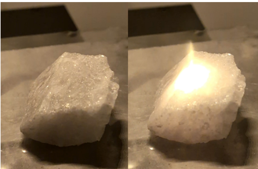
◀ Zwei Fotos eines Salzgesteins im LIBS-System, aufgenommen durch ein gefärbtes Sicherheitsglas. Links ist die Probe ohne und rechts mit der Plasmaflamme zu sehen. Two photos of a salt rock in the LIBS system, taken through a coloured safety glass. The left image shows the sample without the plasma flame, and the right image shows it with the plasma flame.
