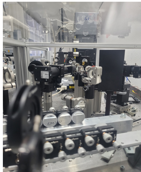
Abbildung 3: Pump Probe Setup. Im Vordergrund sind Teile des Kompressor-spiegelarrays zu erkennen, dahinter die Probenbeobachtung und die Goldprobe. Figure 3: In the foreground, parts of the compressor mirror array are visible; behind them are the sample observation optics and the gold sample.
