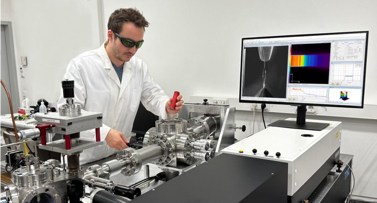
Abb. 5: Kompakter Laboraufbau zur hochauflösenden Röntgenabsorptionsspektroskopie, Bild: Institut für Nanophotonik Göttingen e.V. & Advanced Microfluidic Systems GmbH.
