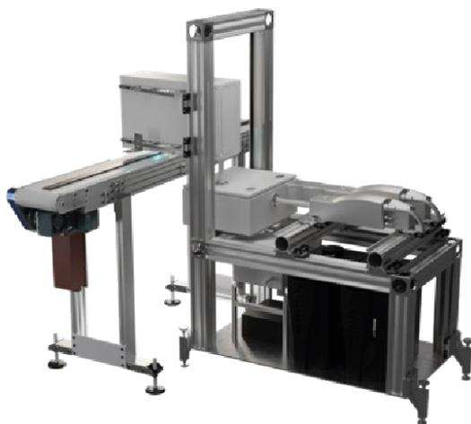
◀ Schematische Ansicht des LIBS-Moduls am Förderband. Schematic of the LIBS module on the conveyor belt.
