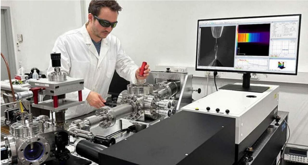
Abb. 1: Kompakter Laboraufbau zur hochauflösenden Röntgenabsorptionsspektroskopie, Bild: Institut für Nanophotonik Göttingen e.V. & Advanc.
