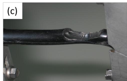
Schematische Darstellung des Effekts der Schwefelverknüpfungen auf die Stabilität von Kautschukelastomeren: (a) Polymer ohne Einfluss äußerer Kräfte und (b) unter Zug entlang einer Richtung. Mechanische Zugkräfte werden durch die Verknüpfungen unter den Polymerketten übertragen und verteilt. (c) Foto des strukturellen Versagens eines Elastomerproduktes unter Zug durch mangelnde Verknüpfungen.
