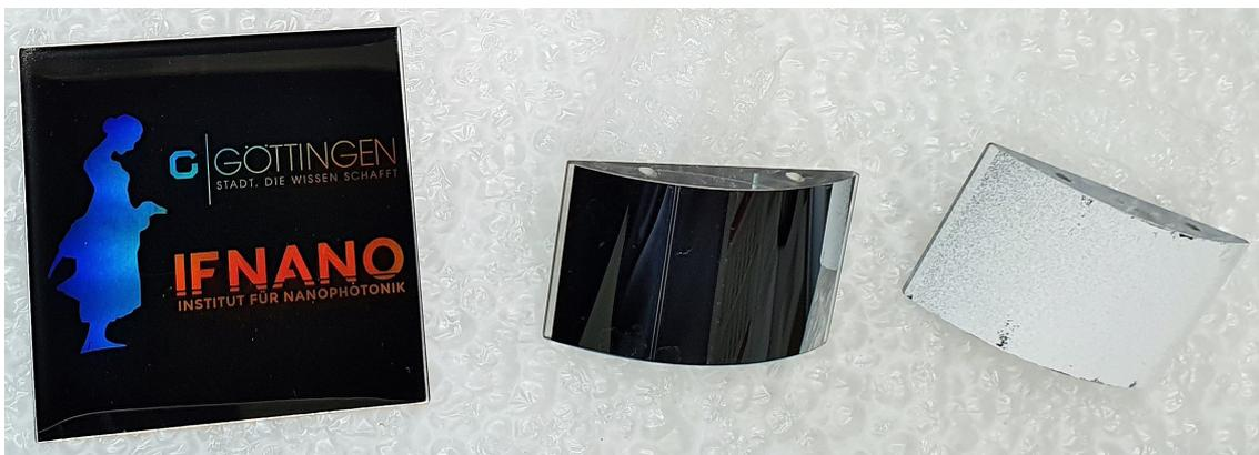
Abbildung 2: Diffraktive Strukturen (links als Designmerkmal) konnten bislang nur auf ebenen Oberflächen geschrieben werden. Mit Z-Shifter sollen auch gekrümmte Oberflächen (Mitte) beschrieben werden. Für die Erfassung mit dem 3D-Scanner werden die Werkstücke mit einem Mattierungsspray versehen (rechts).
