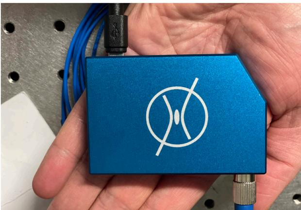
▲ Bild des Faser-Bragg-Grating-Spektrometers.
