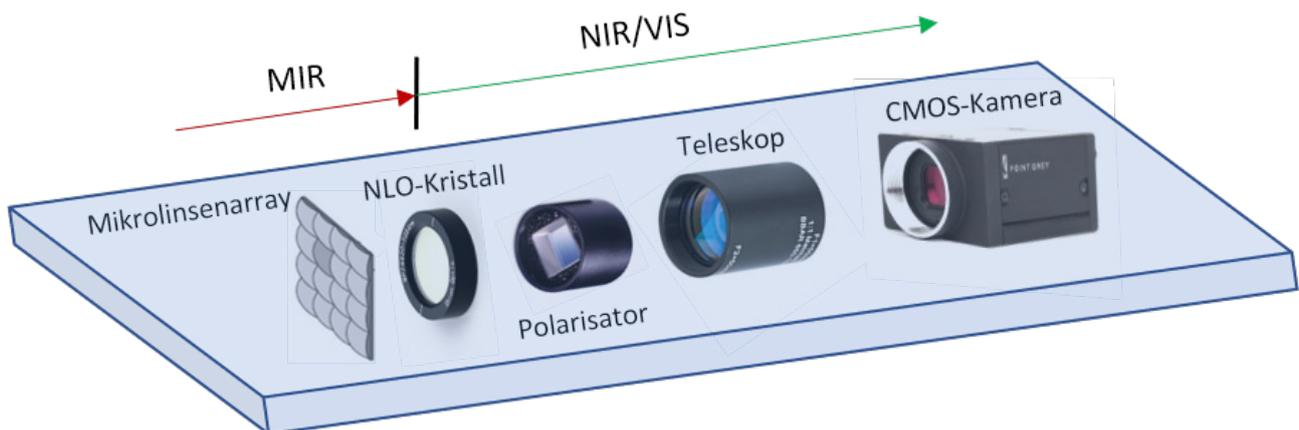
Abbildung 1: Design und Komponenten des Wellenfrontsensors für den MIR-Spektralbereich basierend auf Standard-Komponenten und einem dünnen BBO-Kristall für die MIR-VIS-Konversion. Aufgrund der hohen Ortsauflösung des CMOS-Chips kann ein Mikrolinsenarray mit für die hochauflösende Wellenfrontanalyse geeigneten Werten der Parameter Pitch und Brennweite eingesetzt werden.
