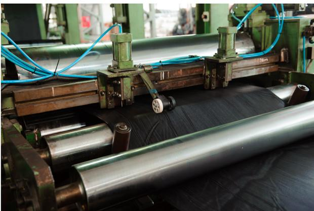
Foto eines gewalzten Kautschukproduktes nach dem Extrudieren.
