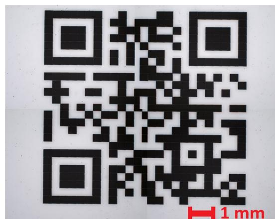
Abbildung 2: QR-Code durch Lasermodifikation von N-SF11-Glas.
