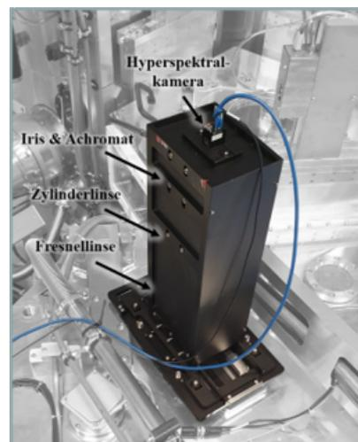
Abbildung 1: (links) Spektrale Transmission aus unkorrigiertem Kamerabild ( $T_{\text{Norm.}}^*$ ) in Abhängigkeit der Bandinformation an einer beliebigen Ortskoordinate (oben) sowie korrigiertes Kamerabild ( $T_{\text{Norm.}}^*$ ) im Vergleich zu Spektrometerdaten. (Rechts) oberer Arm der hyperspektralen Messanordnung, installiert an der Bedampfsanlage der BTE-Bedampfungstechnik GmbH.
