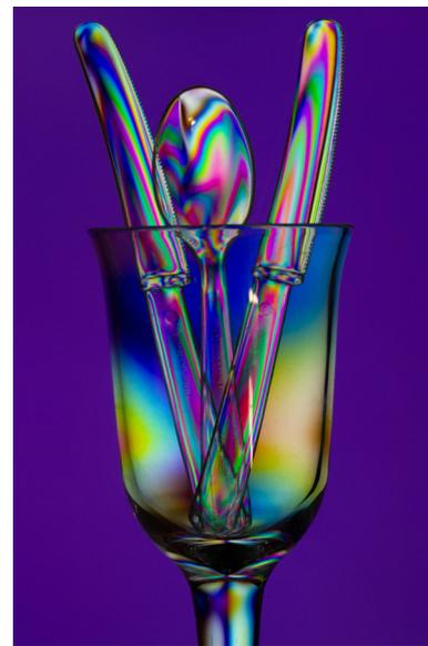
▲ Polarimetrische Weißlichtaufnahme von Plastik. Regionen unterschiedlicher Färbung geben Unterschiede in der Spannung wieder.
