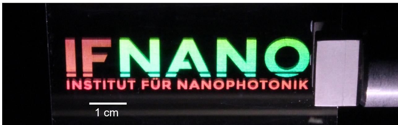
▲ Abbildung 1: Diffraktive Markierung in Form des IFNANO-Logos. Die unterschiedliche Farbwirkung wird durch die gewählte Strukturperiode des jeweiligen Bereichs bestimmt.
