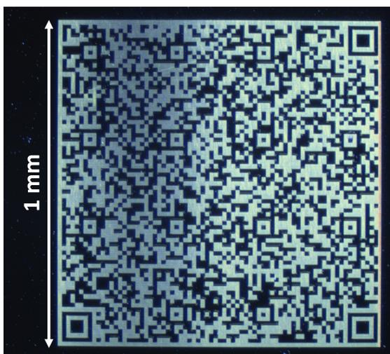
Abbildung 3: Lichtmikroskop-Aufnahme eines lasergeschriebenen, diffraktiven QR-Codes mit Korrekturlevel H, einer Kantenlänge von  $1 \text{ mm}$  und einer Auflösung von  $1 \mu\text{m}$ .
