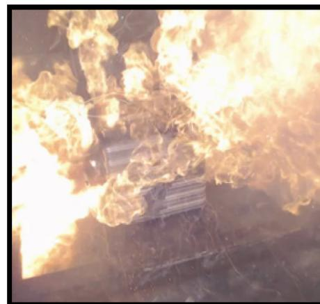
Bild eines Lithium-Ionen-Akkumulators während der Explosion nach einer Havarie.
