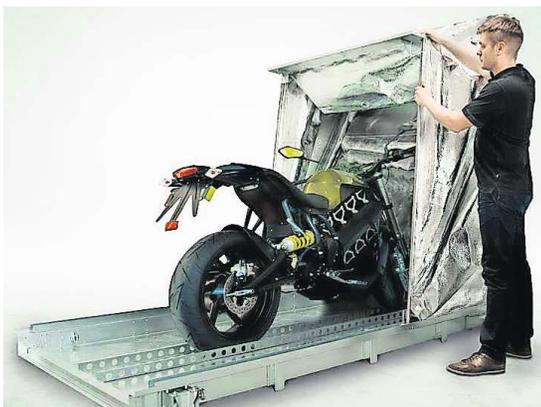
Schottet Elektrofahrzeuge feuersicher ab: E-MobilityProtector von Stöbich technology. FOTO: R
