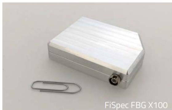
◀ Kleine Bauweise eines Streugitter-Spektrometers.
