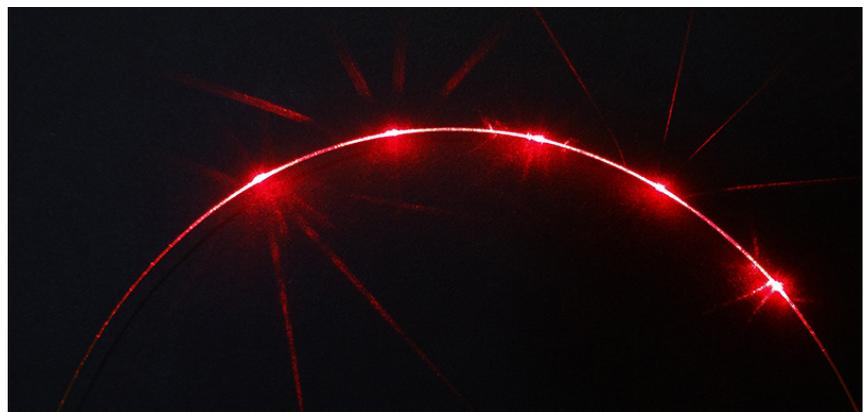
▲ Glasfaser von FiberSense mit 5 Fasergittern bei monochromatischer Beleuchtung.
