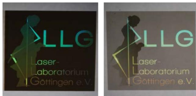
Um ein störungsfreies Übereinanderlegen von Hologrammen zu ermöglichen, wurden daher die Einzelbilder in feine, alternierende Streifen aufgeteilt. Die Breite der Streifen beträgt 40 bis 60  $\mu\text{m}$ , so dass sie bei visueller Betrachtung des Werkstücks nicht auffallen. Innerhalb der alternierenden Streifen liegt dann nur die Linienausrichtung zu jeweils einem Bild vor.
