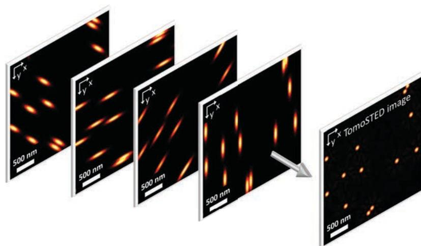
Prinzip der tomographischen STED-Mikroskopie. Aus einer Sequenz von Einzelbildern mit einer hohen Auflösung in nur einer, aber jeweils unterschiedlicher Richtung lässt sich ein zweidimensional hochaufgelöstes Bild rekonstruieren.
