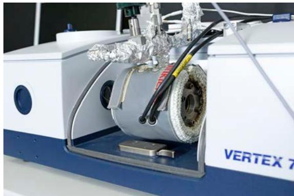
◀ FTIR-Spektrometer mit angeschlossener Druckzelle zur Messung verschiedener Konzentrationen und Zusammensetzungen des Verbrennungsabgases.
