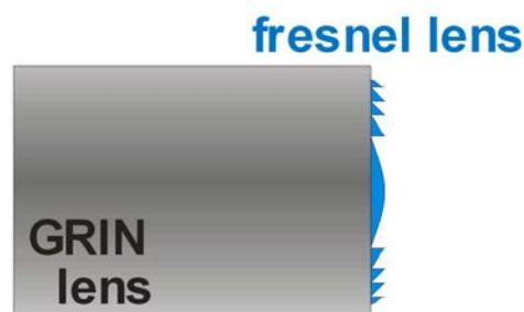
◀ Schematische Darstellung einer hybriden Mikrooptik, die eine Gradientenindex-Linse mit einer Fresnellinse kombiniert. Schematic representation of a hybrid microoptical element combining a gradient index lens with a Fresnel lens on the front surface.
